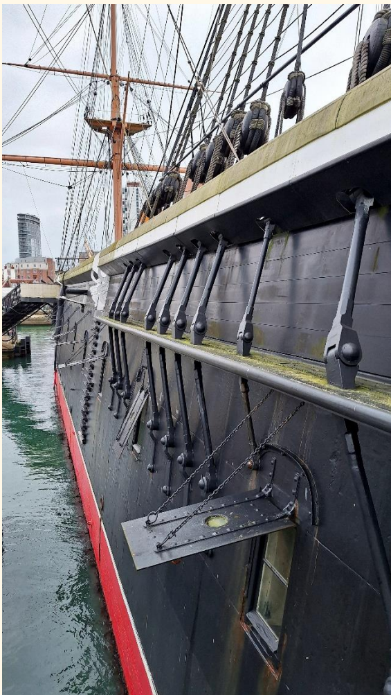
← A Warrior acél bordázatú, de fa testű hajó. A bordázathoz 457 mm vastag tikfa palánkot erősítettek, amire került a 114 mm vastag kovácsolt acél páncélzat.
